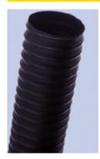
Flexibler, zweilagiger Neoprenschlauch mit verdeckt liegender Federstahldrahtspirale sowie außenliegender Glaskordel
