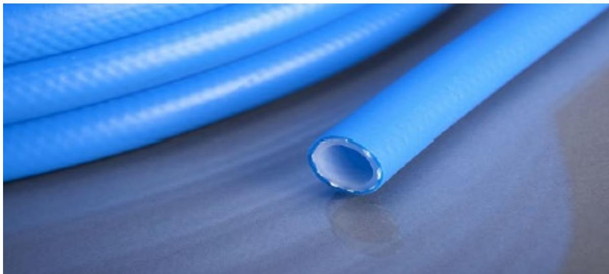
Mehrschichtiger TPE-Schlauch, außen blau mit Polyesterfadeneinlage, weiße und transparente Innenlage.
