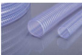
Sehr robuster, transparenter Saug- und Druckschlauch, mit in die Wandung eingearbeiteter Stahlspirale. Wandung aus antitoxischem PVC. Innenwandung glatt. Geeignet für den Transport von flüssigen und festen Medien bei hohem Vakuum und Druck. Durch die Transparenz ist eine gute optische Kontrolle der Vorgänge im Schlauch während des Arbeitsvorganges möglich.
