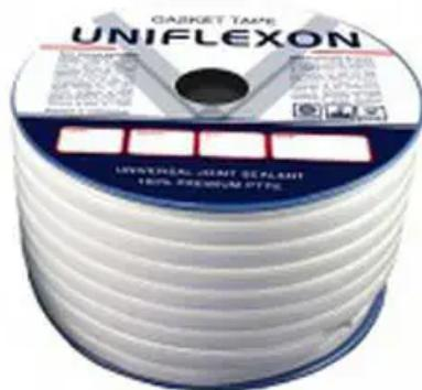
PTFE-Flachdichtband besteht aus virginal expandiertem PTFE ( ePTFE). Dieses ist besonders weich und anpassungsfähig sowie praktisch unbegrenzt chemisch Beständig. Das PTFE-Dichtband passt sich beim Verpressen an die Dichtfläche, beispielsweise das Luftkanalprofil, an und bildet einen dünnen, reißfesten Dichtfilm. Die bänder können als universell statische Dichtung und schnelle Reparaturen verwendet werden.
