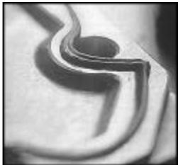
Flüssige Flächendichtungen von Loctite verhindern dauerhaft Leckagen, durch vollständigen Oberflächenkontakt, bei dem Kratzer und Rautiefen mit dem Dichtstoff aufgefüllt werden. Bereits unmittelbar nach der Montage wird eine gute Beständigkeit gegen niedrige Drücke erzielt. Innerhalb von ca. 24 Stunden entsteht eine stoffschlüssige Verbindung.
