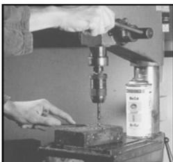
Durch seine besonders hohe Schmierwirkung ermöglicht WEICON Bio - Cut größere Schnittgeschwindigkeiten, höhere Standzeiten und dadurch auch eine höhere Schneidleistung der Werkzeuge.
