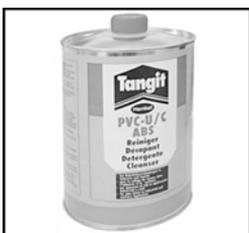
Reiniger auf Basis von Aceton / Tetrahydrofuran stabilisiert. Zum Reinigen von PVC - U (hart) und PVC - C Klebeflächen für die anschließende Verklebung bei PVC - U (hart) mit Tangit bei PVC - C mit Tangit 95 °C. Frei von Chlorkohlenwasserstoff.
